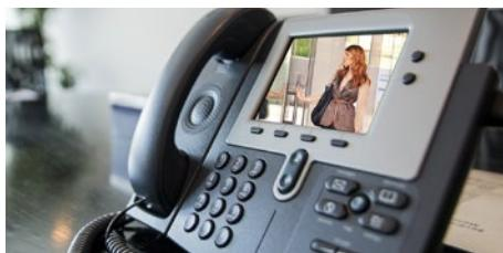
Über SIP (Session Initiation Protocol) wird auch die Einbindung in eine IP-Telefonanlage unterstützt. Wenn zum Beispiel die Türklingel mit einem kompatiblen Telefon verbunden ist, kann beim Klingeln das Livebild der Kamera auf dem Telefon eingeblendet werden.
