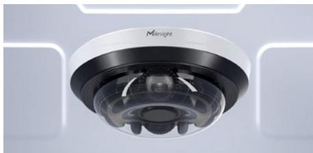
4 Kameras in einer: die vier Objektive können individuell ausgerichtet werden und verfügen alle über einen 3-9mm Motorzoom.
