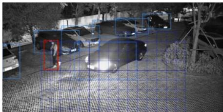
In einigen Videoanalyse-Funktionen kann die Kamera die erfassten Objekte zwischen Personen und Fahrzeugen unterscheiden. Das ermöglicht eine effizientere Alarmierung bei bestimmten Ereignissen.
