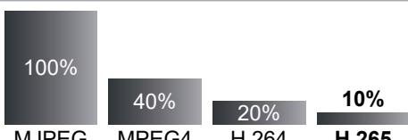
Komprimierungsverfahren verringern den Datenverkehr auf dem Netzwerk und erhöhen gleichzeitig die Aufzeichnungsdauer.
